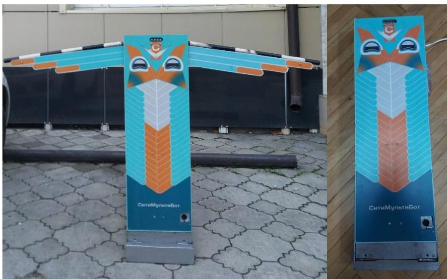
*Рис. 2. Внешний вид роботизированного модуля управления парковочным местом*
