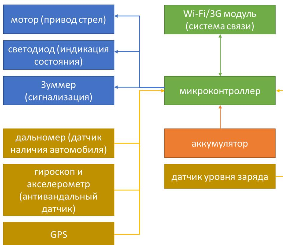
**Рис. 3.** Схема реализации робота-парковщика
