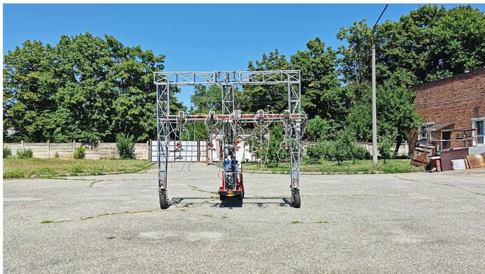
*Рис. 1. Автономный робот для защиты растений*
