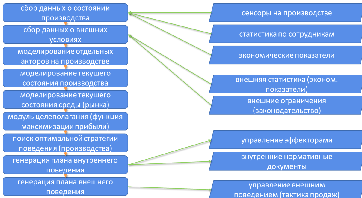
Рис. 3. Схема системы управления процессом производства робототехнических комплексов
